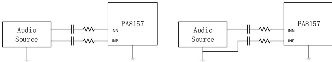
图 14. 典型差分/单端输入连接图
